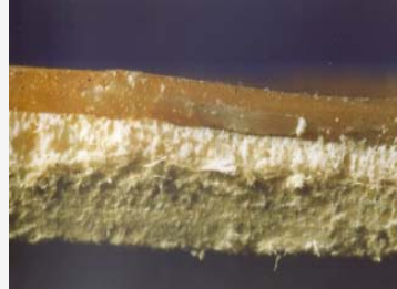
Mehrschichtiger Bodenbelag (Asbestkarton)
